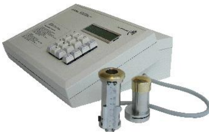
Рисунок 2.1 – Прибор ПСХ-10а для измерения удельной поверхности тонкодисперсных материалов
